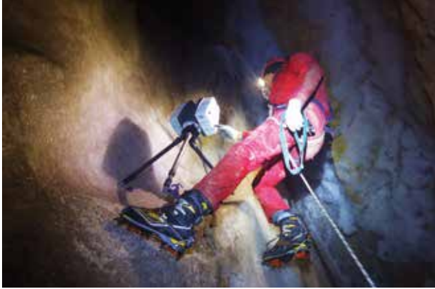
Farouk Kadded, tecnico francese di Leica Geosystem, mentre si appresta ad eseguire l'ultima scansione dalla lingua di ghiaccio dopo una lunga serie di operazioni necessarie per posizionare il laser scanner Farouk Kadded, a French technician from Leica Geosystems, as he prepares to take the final scan of the ice tongue after the long series of operations required to position the laser scanner
